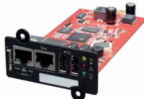
Карта SNMP с подключением датчика окружающей среды
