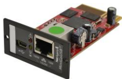
Карта мини SNMP с возможностью подключения датчика
