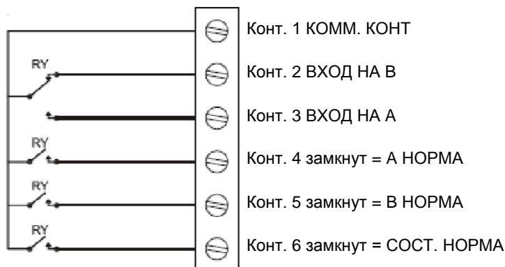
Рис. 2: Базовая схема порта контактов.
