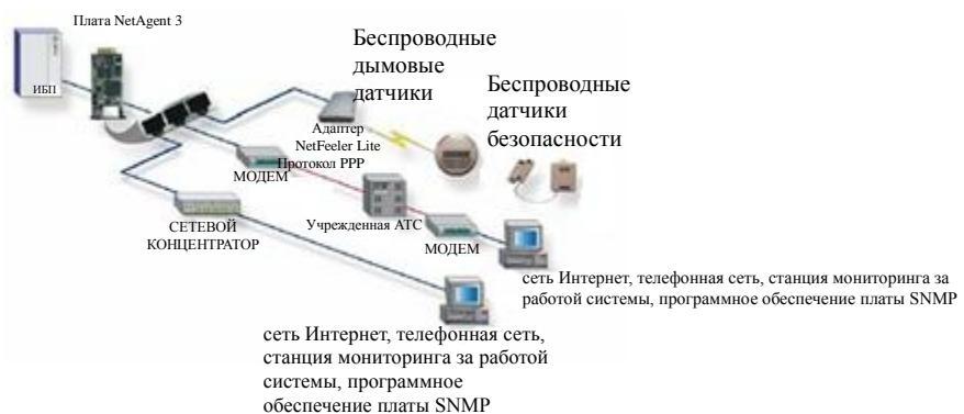
Стандартная топология сетевого управления ИБП.
