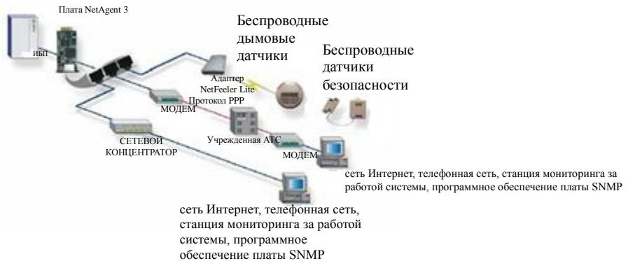
Стандартная топология сетевого управления ИБП
