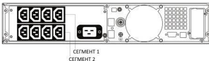
Рисунок 1.7 – ИБП напольно-стоечного исполнения СИПБ1,5КА.9-11, СИПБ2КА.9-11, вид задней панели
