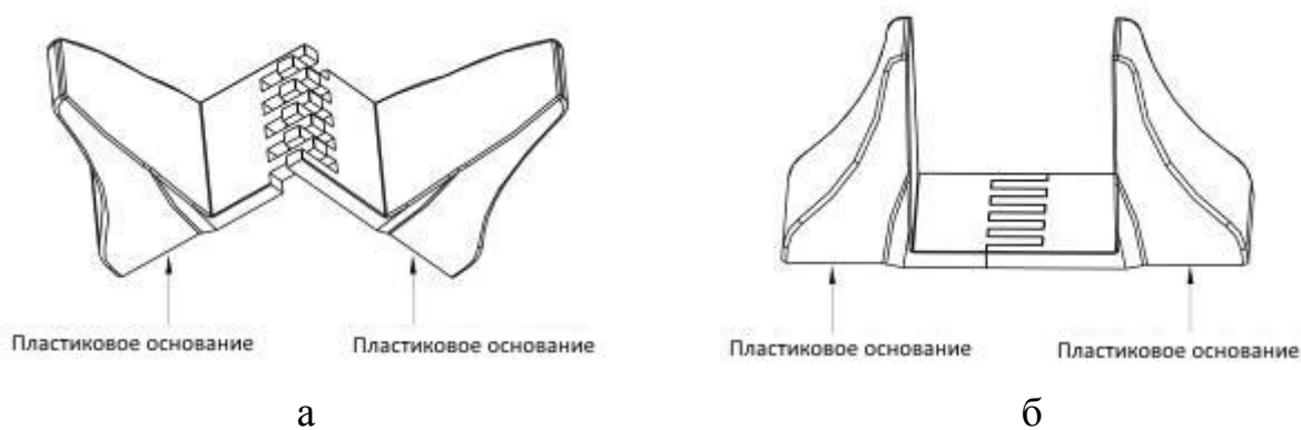
Рисунок 2.5 – Порядок сборки стойки для напольной установки ИБП
