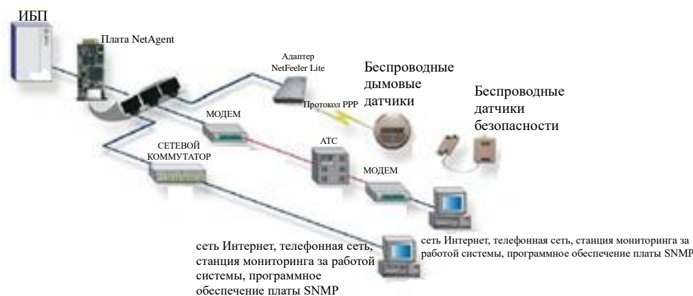
Стандартная топология сетевого управления ИБП
