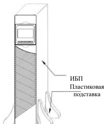
Рисунок 12. Поворот ЖК-дисплея ИБП при напольной установке.
