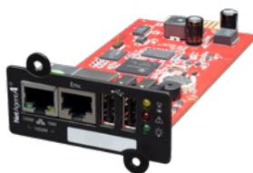
Карта SNMP с подключением датчика окружающей среды
