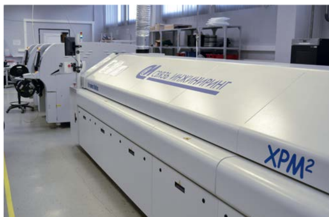
Печи конвекционного оплавления припоя JT RS-1000II-N и Vitronics Soltec XPM 2
