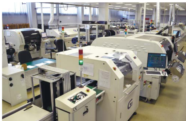
Автоматизированный монтаж SMD компонентов
